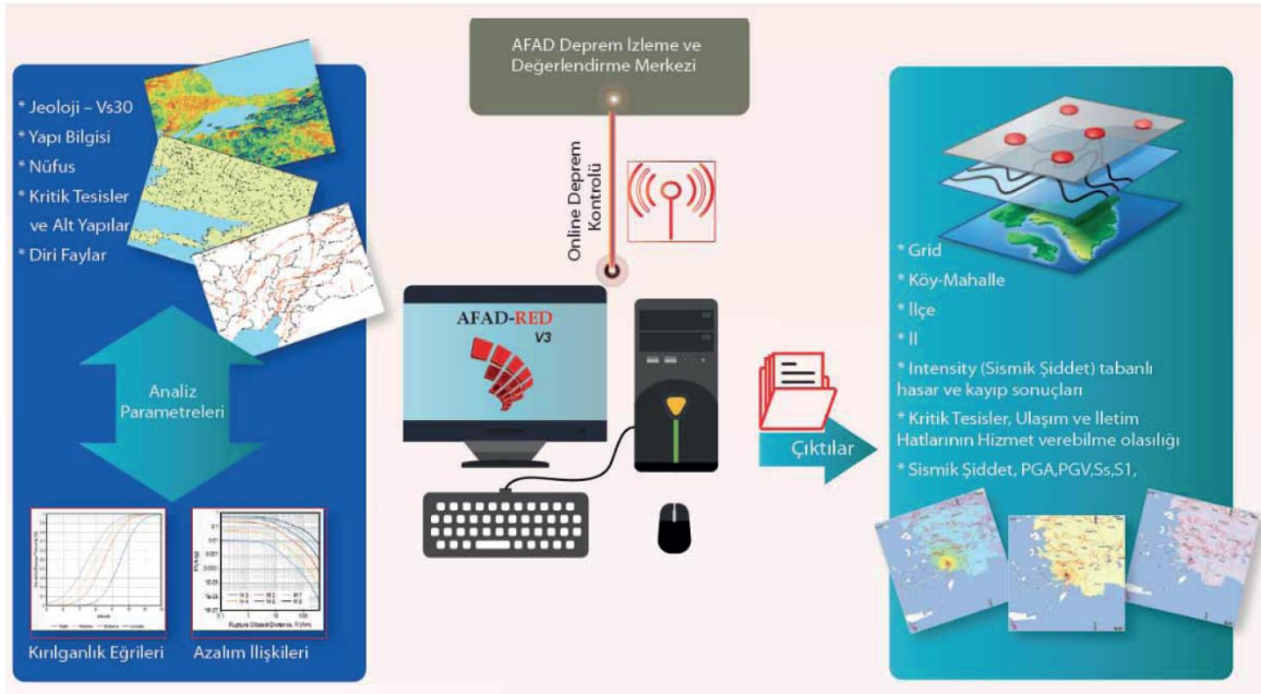
Şekil 2.12. AFAD-RED Çalışma Prensibi
